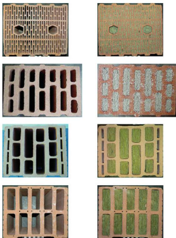
Bild 1. Vier für die Untersuchungen beispielhafte Lochbilder (links: ungefüllt, rechts: gefüllt)
