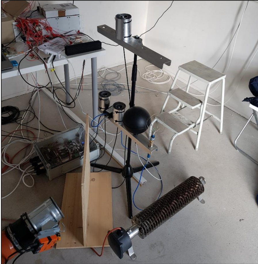
Abbildung 4: Behaglichkeitsmesstand mit Sensoren in Strahlungsschilden; Rippenheizkörper und Zuluftrohr
