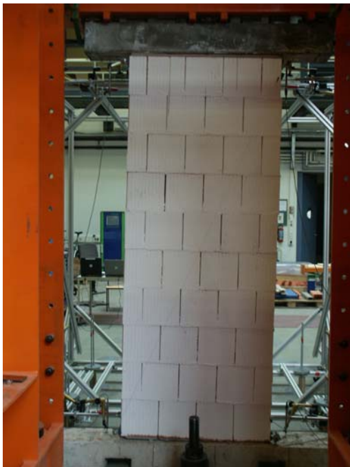
Bild 4: Prüfkörper aus HLzB8-0,6, Wandlänge 1,00 m, Auflast 30 kN nach Versuchsende (klaffende Fugen an Wandkopf und Wandfuß, Versuchsabbruch, da maximaler Kolbenweg erreicht wurde)
