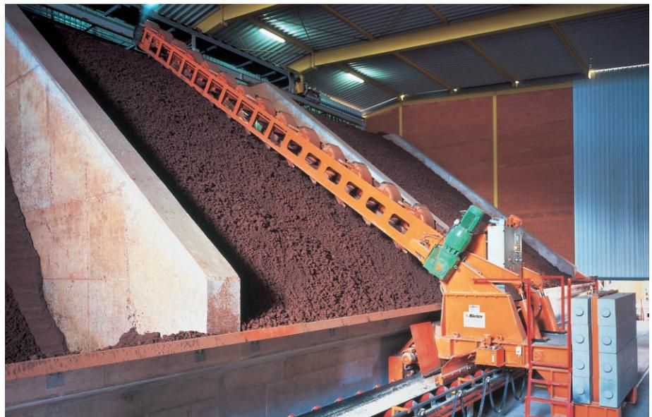
Bild 26 Homogenisierung des Tons im Sumpfhaus.
