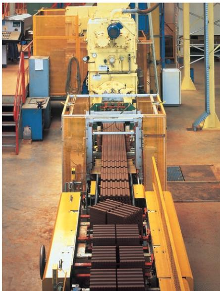
Bild 27 Drahtabschneider.
