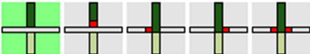
Bild 192 Stoßstellen mit Entkopplungsschicht(en)
