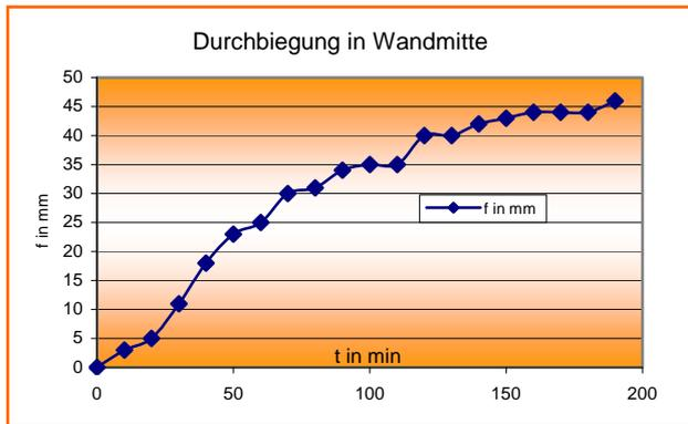
Bild 3: Durchbiegung in Wandmitte während des Versuchs in [3]
