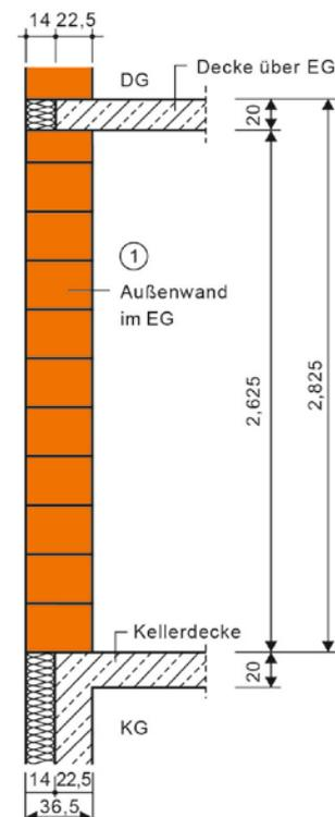
Bild 1: Schnitt Außenwand
