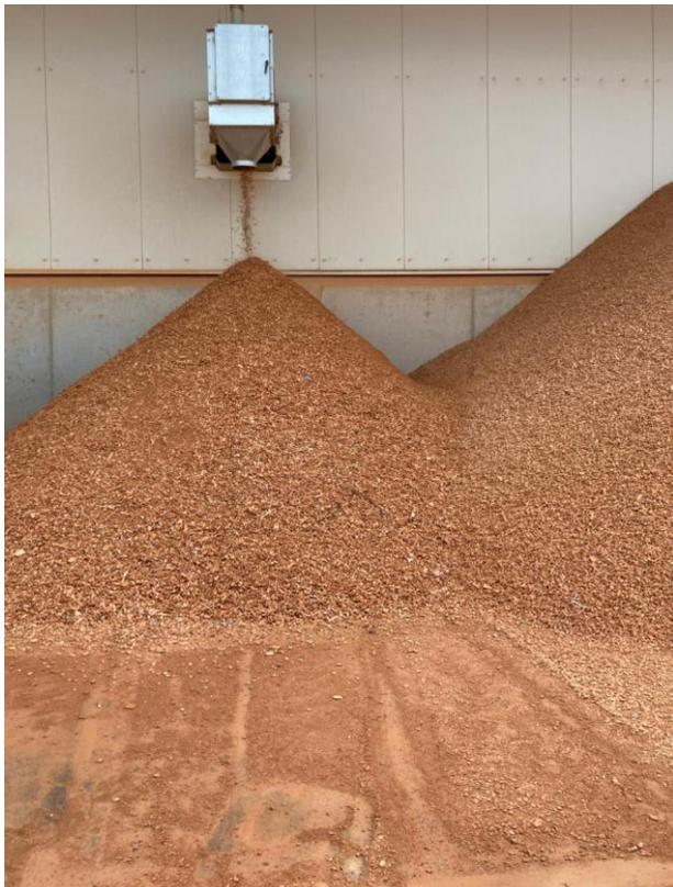
**Bild 02** Wiederverwendete Ressource: Ziegelmehl ist eines der Beispiele für die Wiederverwertung von Abbruchmaterialien in der Ziegelindustrie.
